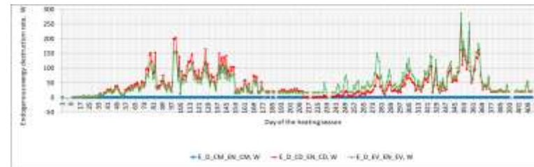
Динаміка зміни впродовж опалювального сезону зміни додаткової частини ендогенної частини деструкції ексергії у компонентах ТНУ у випадку очищення/заміну конденсатора
