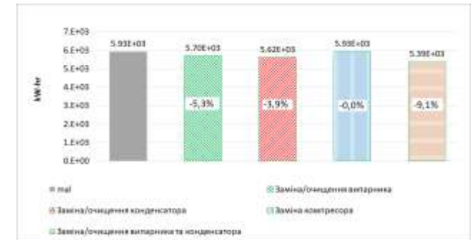
Зміна споживання електроенергії ТНУ у другому сезоні після проведення предиктивного обслуговування компонентів
