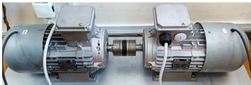
Пара «СДПМ – асинхронний двигун»
