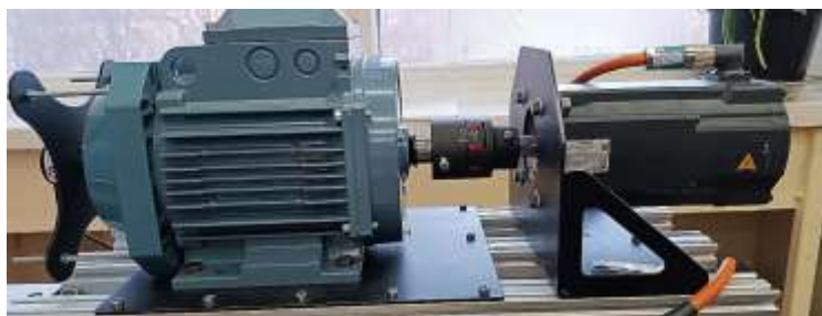
Пара «синхронний реактивний двигун – СДПМ»
