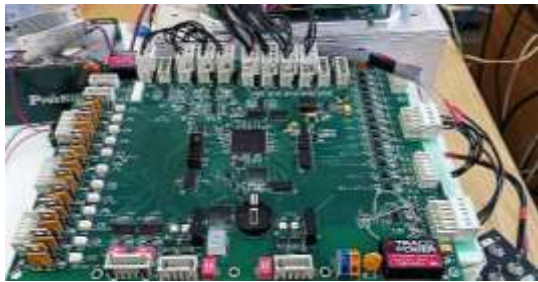
Лабораторні дослідні зразки електроприводів на основі керуючих контролерів TMS320F28335
