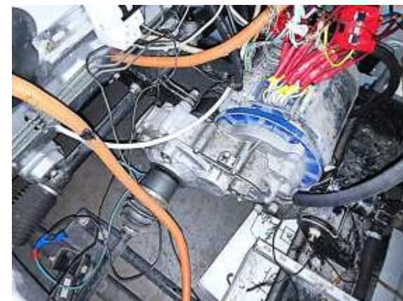
Тяговий двигун (АД) з редуктором
