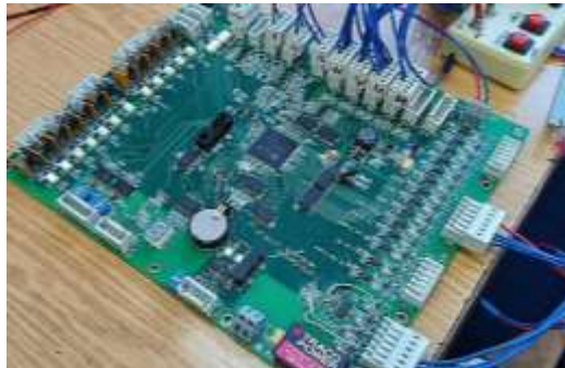
Лабораторні дослідні зразки електроприводів на основі керуючих контролерів TMS320F28335
