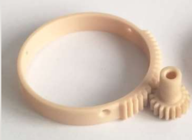
Зубчаста передача з передавальним числом 6.33
